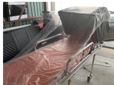
カバーを開けた状態。周囲を黒色の布で囲むため患者のプライバシーを守る一方で、上面が透明のため救急隊員は患者の様子を見ることができます（左） 全身をカバーするビニールも装着できます（右）
