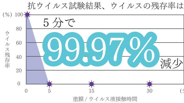
銀雪に使用している漆喰塗料についてのウイルス E(エンベロープあり)に対する抗ウイルス試験(大学研究所での実験結果)
